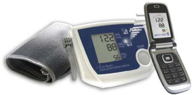
Abbildung 2. Blutdruckmessgerät UA-767 Plus NFC (A&D, Japan) mit integrierten NFC-Modul (Austrian Research Centers / eHealth systems) und Nokia 6131 NFC (Nokia, Finland)a
