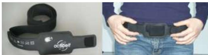
Abbildung 1: Der actibelt in der flexbelt-Befestigung und wie er am Körper getragen wird.
