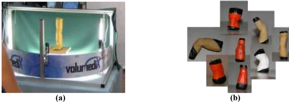
**Abbildung 1: (a) Modellaufbau des Messsystems, (b) Verschiedene Tonmodelle von Extremitäten unterschiedlicher Morphologie**
