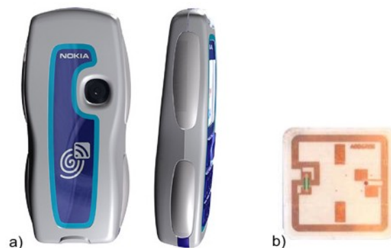
Abbildung 2: Nokia 3220 mit NFC Cover (a) und MIFARE RFID Tag (b)
