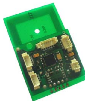
Abbildung 3: NFC Modul in SMD Bauweise
